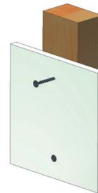
Gipsplatte auf Holzunterkonstruktion
